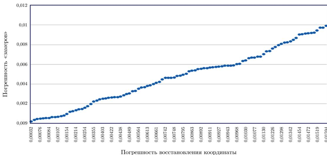
Рис. 1. Влияние погрешности замеров на точность восстановления координаты
