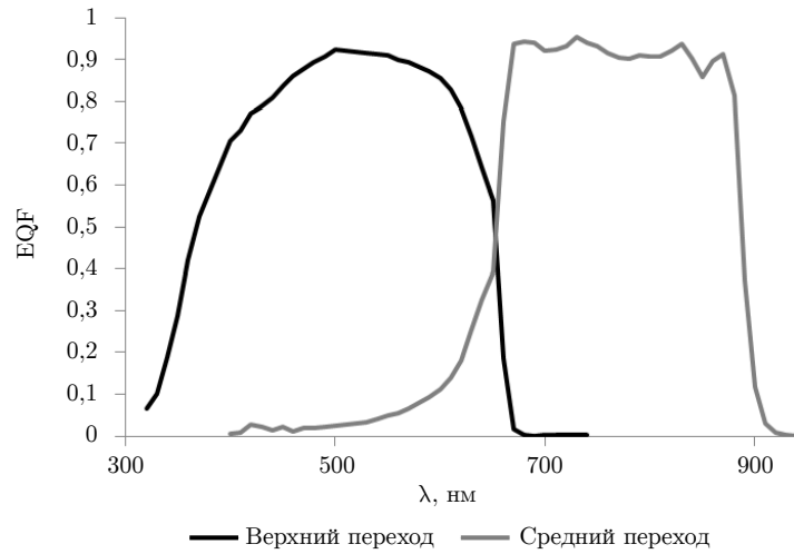
Рис. 1. Внешняя квантовая эффективность исходной сбалансированной по плотностям токов верхнего и среднего переходов структурой
