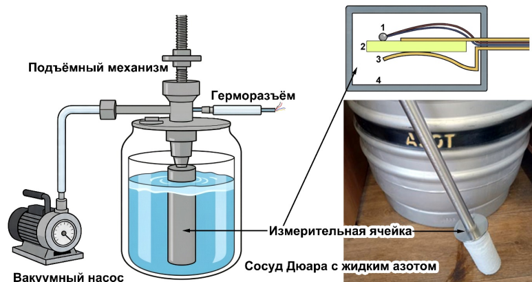
Рис. 1. Схематическое изображение и внешний вид измерительной ячейки: 1 — термопара pt-1000; 2 — измеряемый пьезоэлемент; 3 — измерительные электроды; 4 — корпус ячейки
