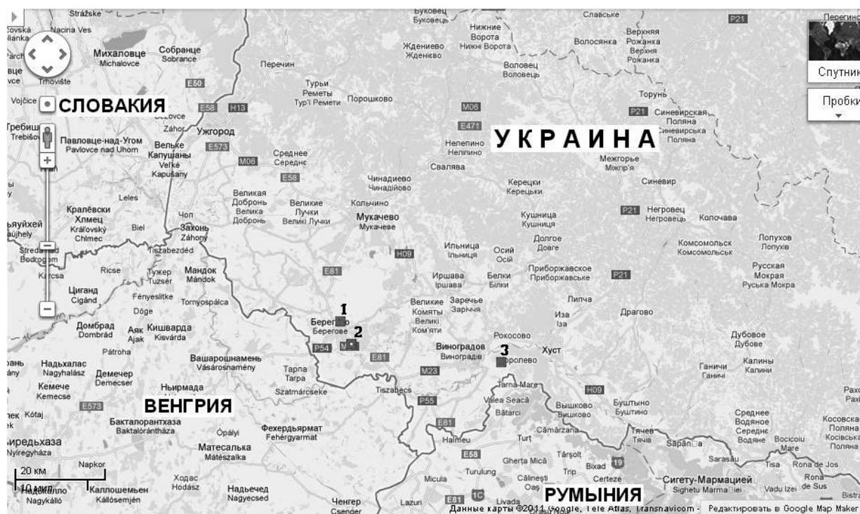
Рис. 5. Размещение пунктов деформографических (кварцевые деформографы) наблюдений на территории Украинского Закарпатья (на картооснове Google) (1 — РГС «Берегово», в штольне которой установлен маятник-наклономер, 2 — пункт «Мужиєво»; 3 — РГС «Королево»)
