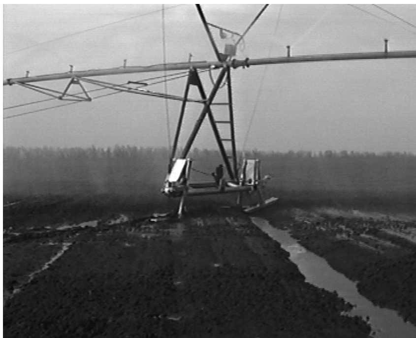
Рис. 1. Опытный образец шагающей опоры дождевальнoй машины
