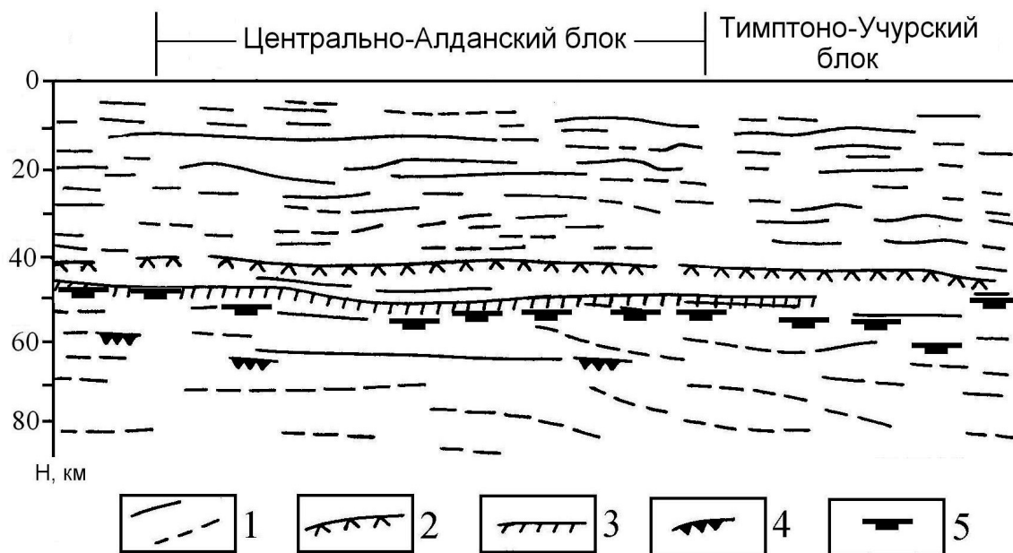
Рис. 4. Положение границы Мохо Центрально-Алданского блока Алдано-Станового щита, определённой различными методами по линии геотраверса 3-ДВ [1, 2, 10, 12]: 1 — границы обмена волн по данным МОВЗ [2]: а — уверенные, б — неуверенные; 2–5 — положение границы Мохоревича по данным: 2 — МОВЗ [2], 3 — интерпретации аномалий силы тяжести [10], 4 — интерпретации волновых полей близких землетрясений [12], 5 — СГ-ОГТ геотраверса 3-ДВ [1].
