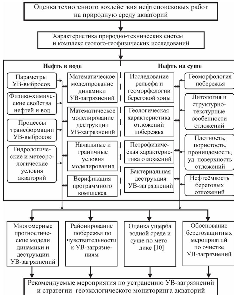
Рис. 1. Блок-схема методики оценки углеводородных загрязнений акваторий
