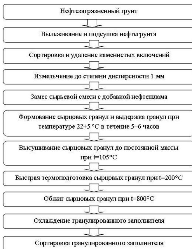
Основные стадии получения гранулированного заполнителя из нефтесодержащего грунта
