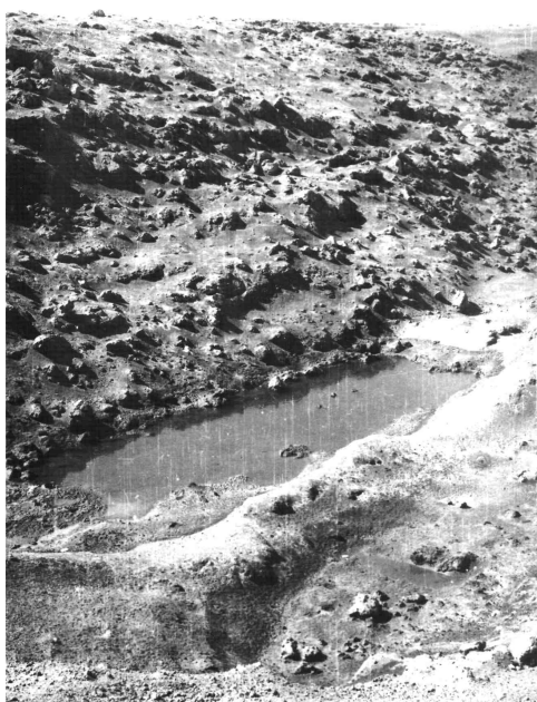
Рис. 3. Грунт, пришедший в разжиженное состояние в результате подземного взрыва
