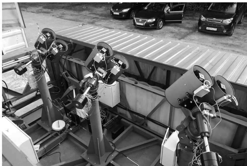
Рис. 4. Общий вид барьерного комплекса КБТ-6х20 из шести телескопов ТГШ-200 на испытаниях в ИПМ им. М.В. Келдыша РАН в Москве
