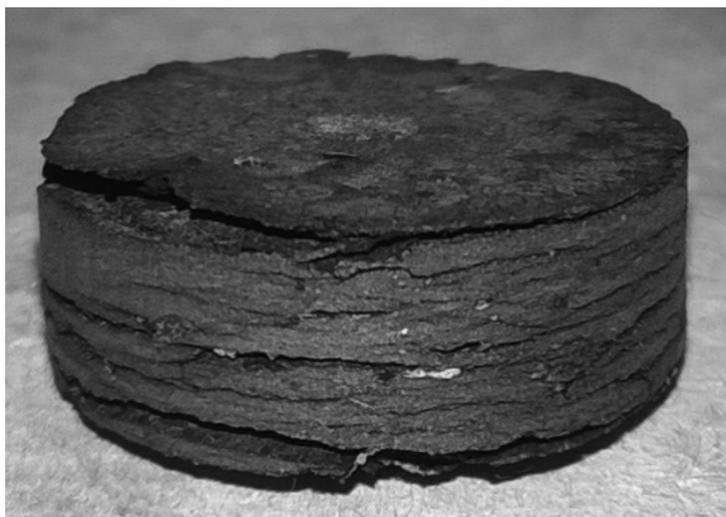
Рис. 2. Фуллеренсодержащий материал в виде таблетки
