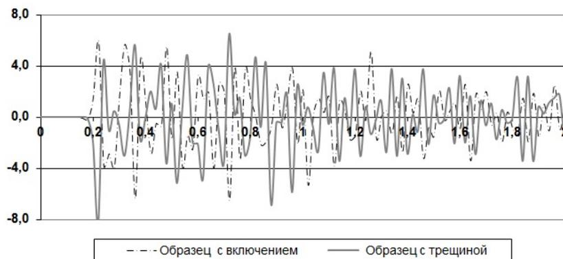
Рис. 2. Поверхностное волновое поле для образцов с трещиной и с включением
